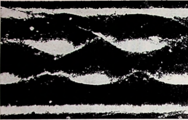
Afb. 7 - Groef van een Pathé „hill and dale”, op dezelfde schaal als afb. 2. Er is bijna geen wand tussen twee opeenvolgende groeven, die bovendien zeer breed zijn. Vandaar de moeilijkheden met het spelen.
