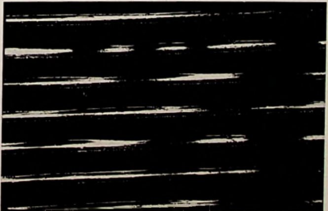
Afb. 6 - Groef van een Edison „hill and dale” opname, op dezelfde schaal als afb. 2. Lichte plekken zijn „hills”, donkere „dales”.
